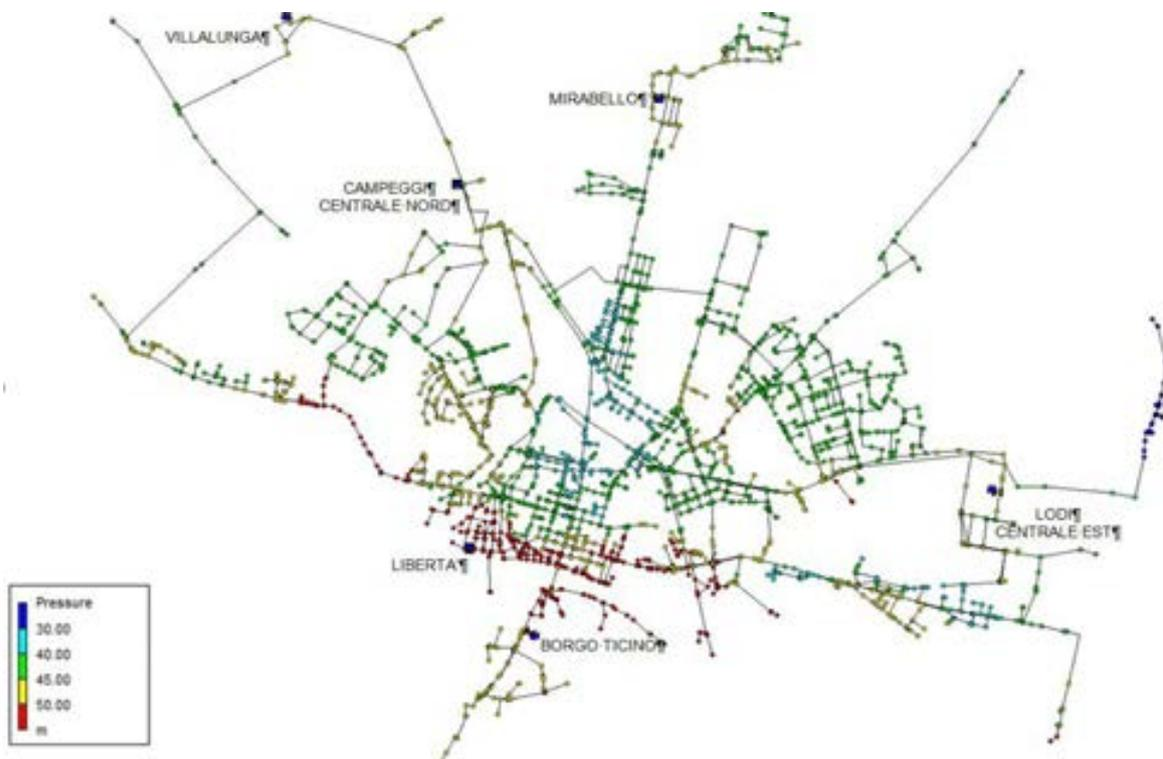
Figura 1.3 - Planimetria della rete - pressione ai nodi nello scenario di stato di fatto (cfr. allegato 1)
