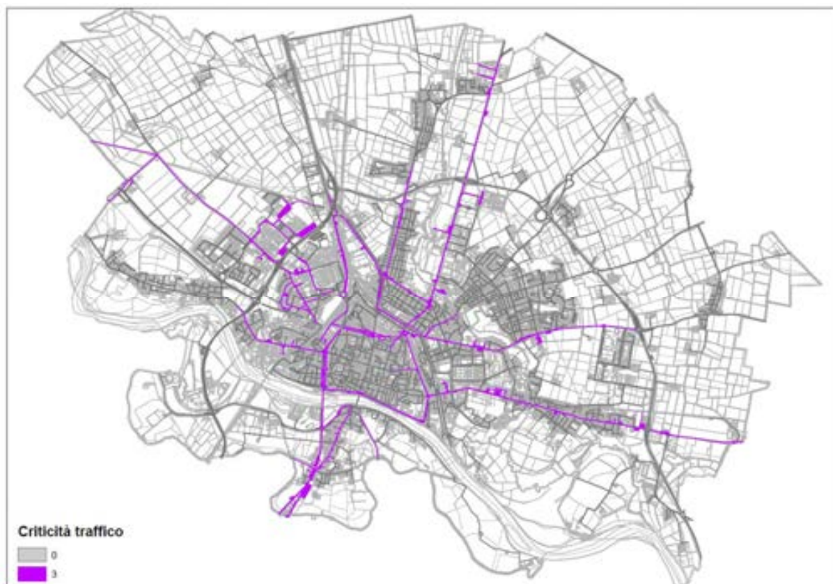
Figura 12.3 - Classificazione delle vie in relazione al flusso veicolare
