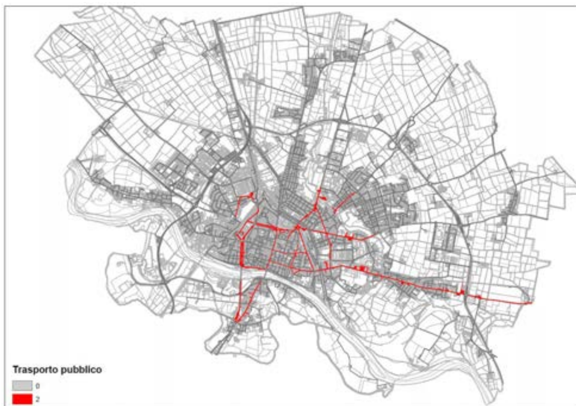
Figura 12.4 - Classificazione delle strade con presenza di TPL
