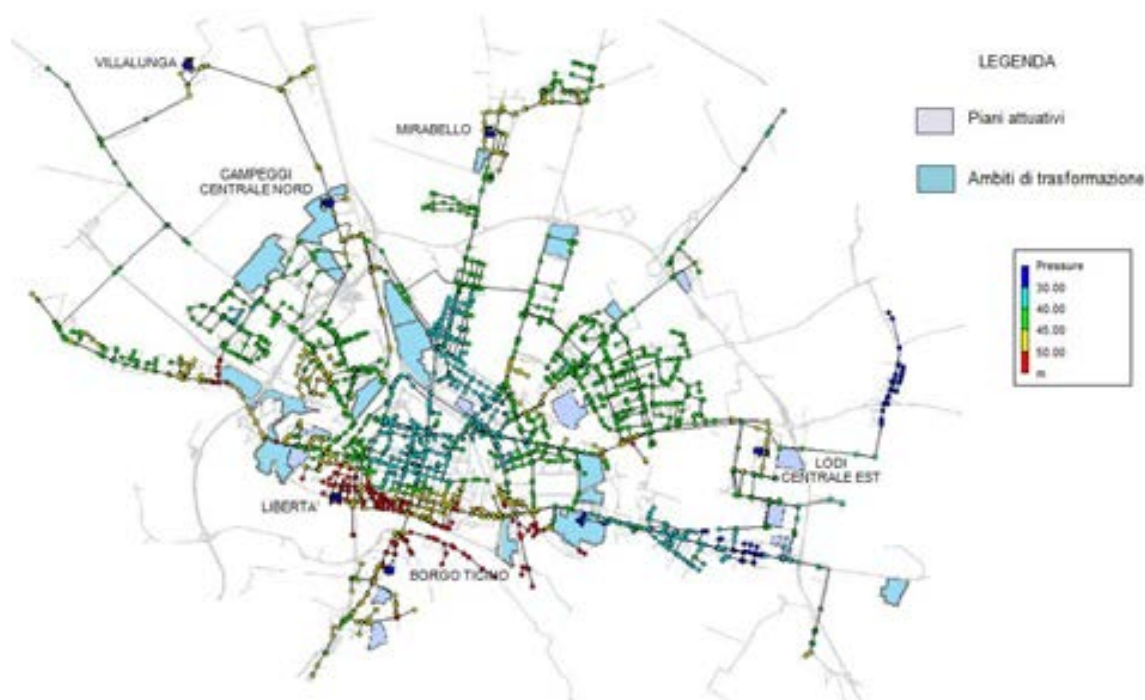
Figura 1.4 -Planimetria della rete - pressione ai nodi nello scenario di piano con riportati gli ambiti di trasformazione e i piani attuativi
