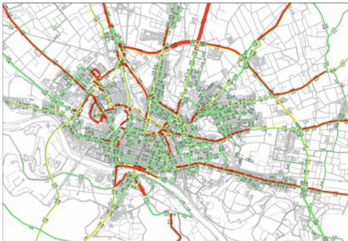
Figura 7.2 - rete attuale: flussi/capacità e in rosso le criticità (fonte: servizio mobilità)
