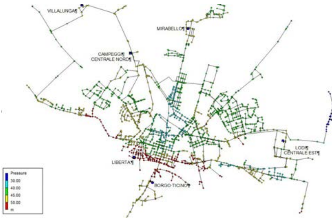
Figura 1.3 - Planimetria della rete - pressione ai nodi nello scenario di stato di fatto (cfr. allegato 1)
