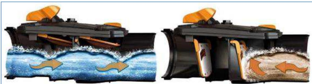
Figura 5.12 – Funzionamento del sistema antiriflusso
