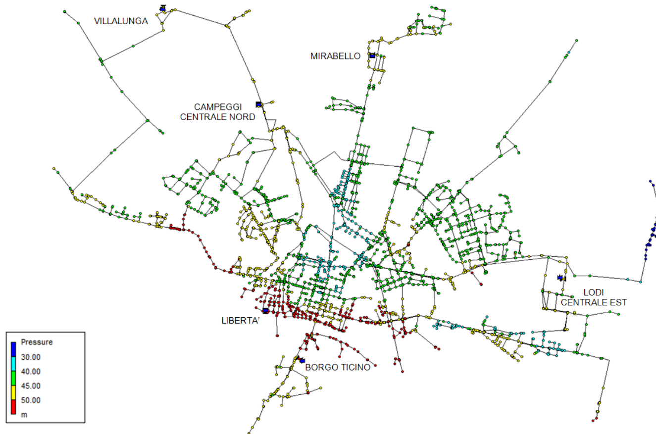
Figura 3.1 - Planimetria della rete: pressione ai nodi nello scenario di stato di fatto
