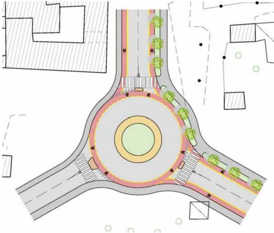
Figura 14 – Esempio di ciclabile riportata in corona di una rotonda diametro uguale o minore di 28 m
