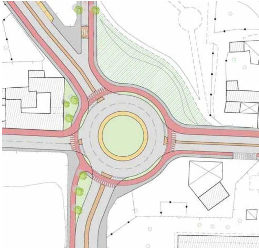
Figura 15 – Esempio di ciclabile riportata in corona di una rotonda diametro maggiore di 28 m
