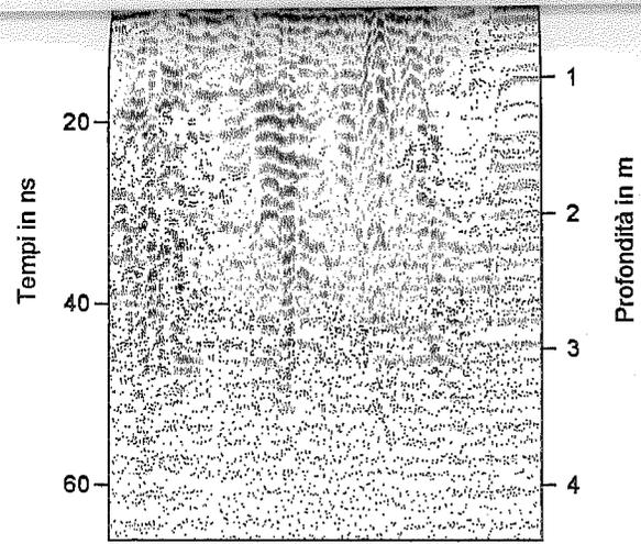
Sezione georadar pv3
