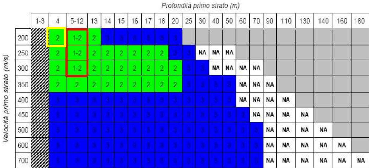
Fig.13 - Abaco che permette di individuare, in base al colore, la curva di riferimento per l'individuazione di Fa, grazie all'intersezione della profondità raggiunta dal primo strato e la sua velocità
