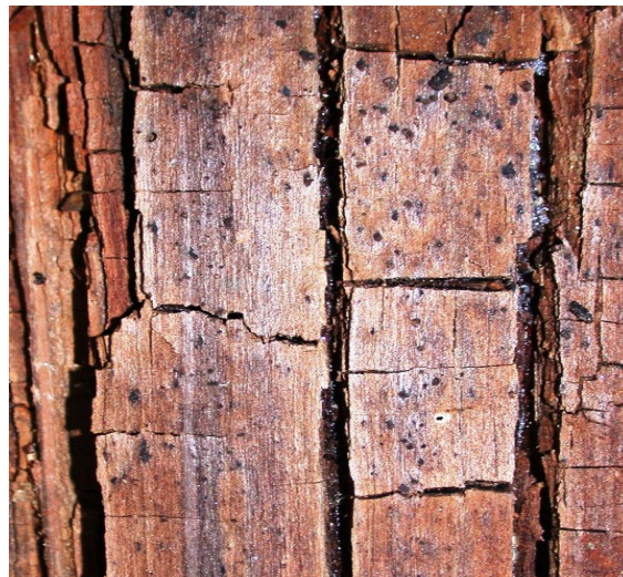
Campione prelevato in situ presenza diffusa di carie bruna
