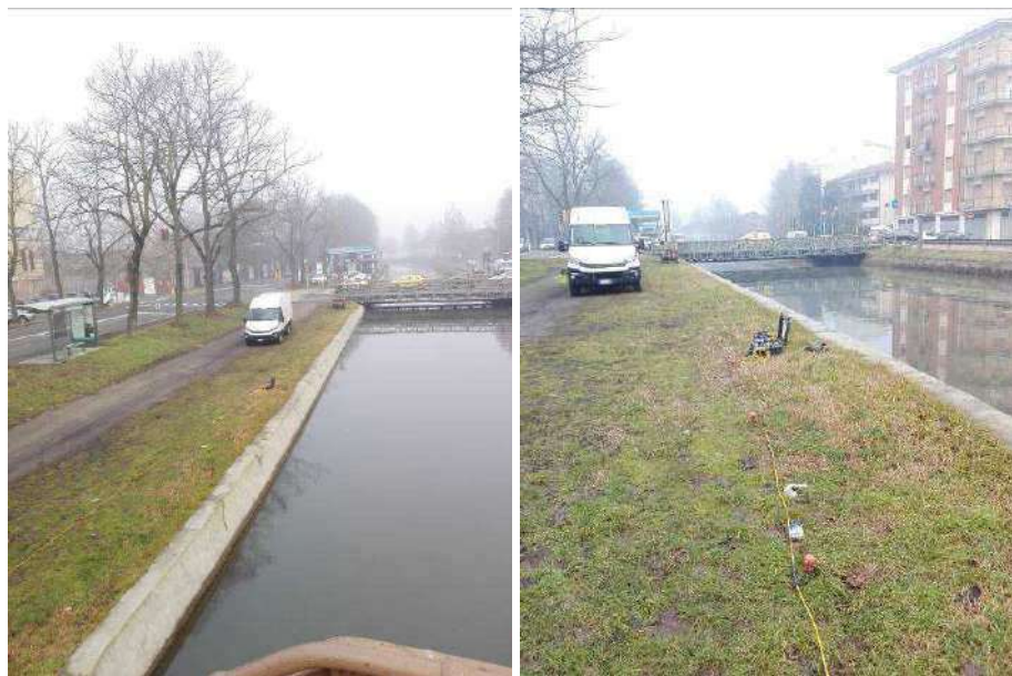
Esecuzione della prova sismica MASW.
