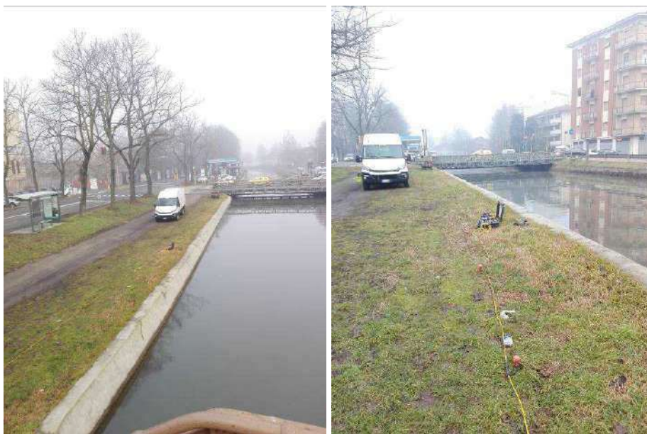
Esecuzione della prova sismica MASW.
