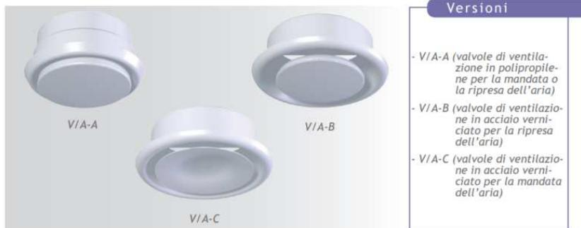
Valvole di ventilazione di colore bianco per la mandata o la ripresa dell'aria. Caratterizzate da un livello sonoro minimo anche per elevate perdite di carico. La regolazione e la taratura della portata avviene mediante la rotazione del disco centrale. Possono essere fornite in quattro diversi diametri, Ø100, Ø125, Ø160, Ø200 mm. Viene fornita con collarino di fissaggio.
