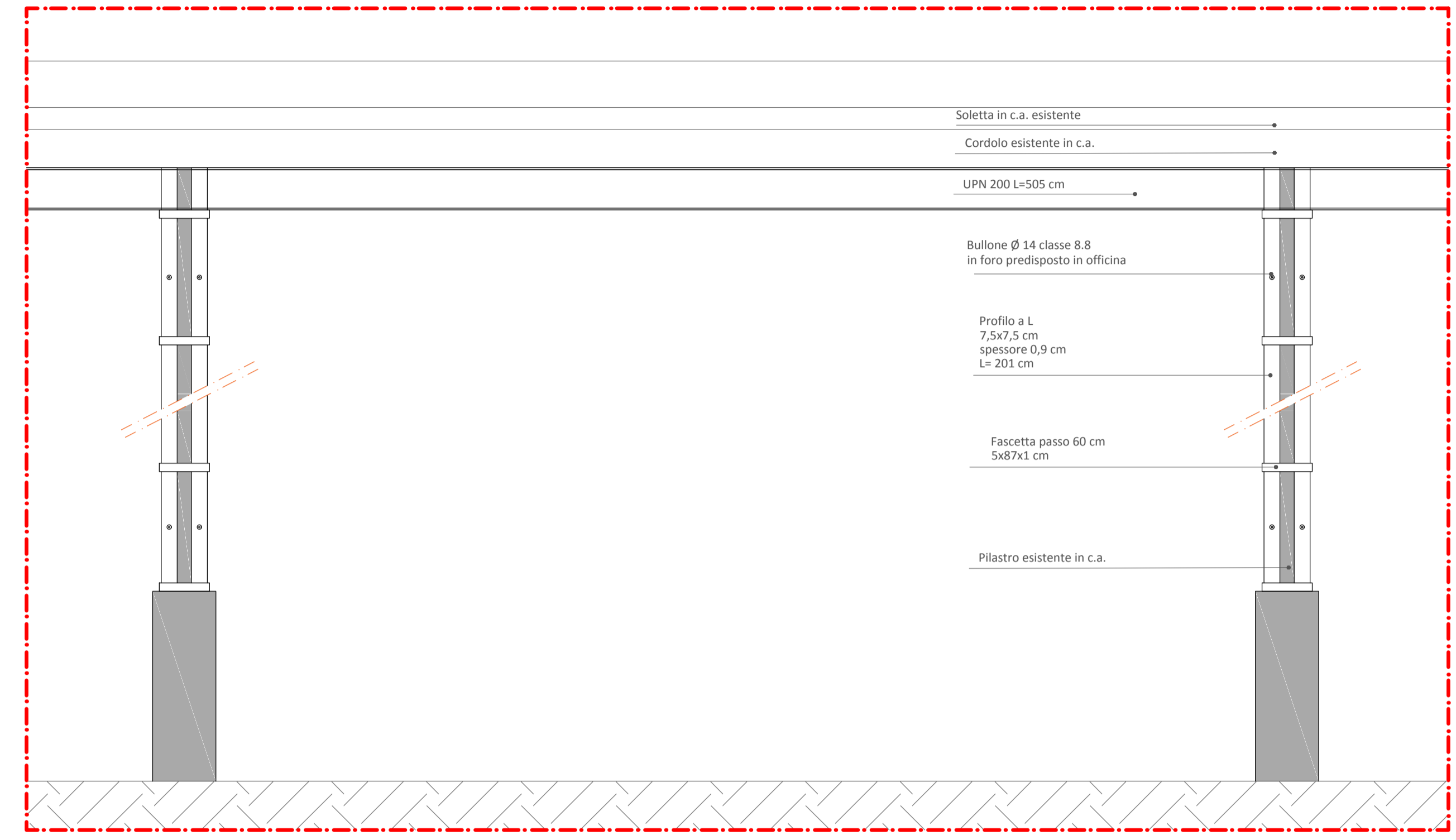
PARTICOLARE COSTRUTTIVO P1 PROSPETTO scala 1:20
