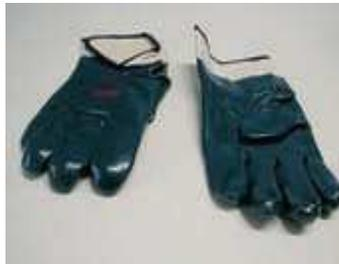
proteggono da tagli, schiacciamenti e abrasioni delle mani. Obbligatori ogni volta che si maneggiano materiali pesanti, con parti taglienti o abrasive, quando si impiegano macchine od attrezzi manuali. Il tipo di guanto deve essere adatto al tipo di lavoro.
